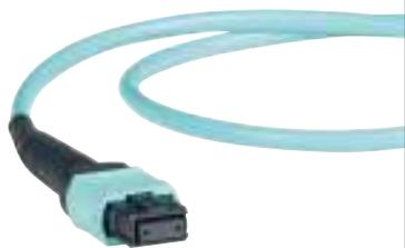
Con la necesidad de soportar múltiples rutas de transmisión, el conector tipo MPO es el conector identificado por el estándar IEEE 802.3 para transmisión 40G y 100G (cuando no se utiliza WDM). Los términos "MPO" y "MTP" se usan indistintamente para este estilo de conector (MPO = nombre genérico). MTP es un conector de estilo MPO y posee mejor rendimiento con menor pérdida de inserción.
