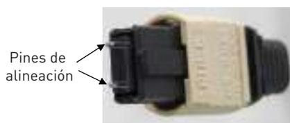
El conector con pines comúnmente se ubica dentro del panel para poder proteger los pines contra daños (es decir, el conector fijo es con pines y el conector que se saca y manipula frecuentemente no los tiene). Por ejemplo, los casetes generalmente tienen pines, y los cables troncales comúnmente no los tienen.
